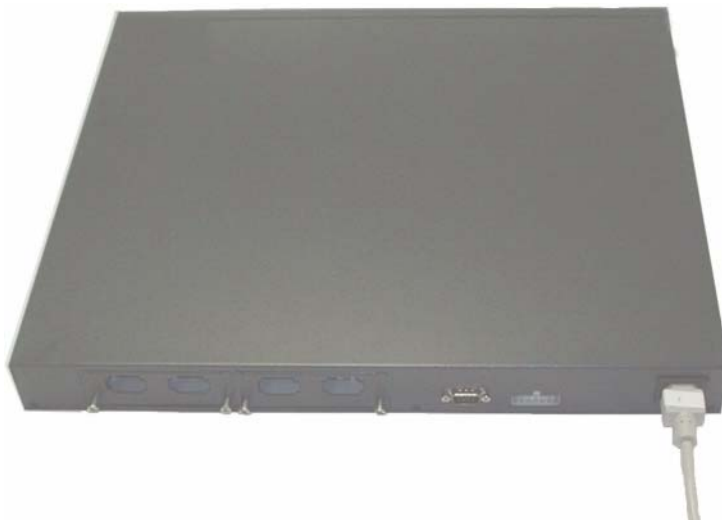
Εικόνα 1-2. Συνδεση καλωδιου τροφοδοσιας
